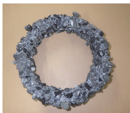
写真-2 硫酸水溶液浸漬後の供試体（左：e-CON、右：セメントコンクリート）
