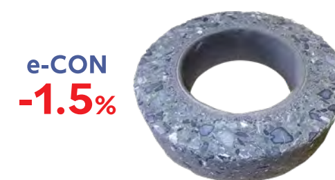
5%濃度の硫酸水溶液に112日間浸漬後の質量減少率
